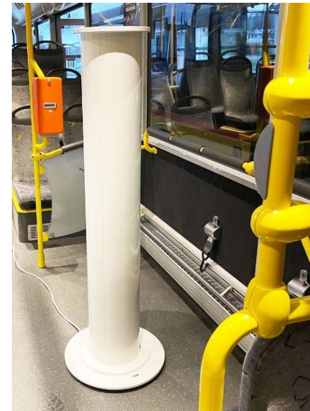
Postauto-Beheizung mit PALLADIO BIO Heizsäule 1260 Watt
